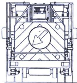
Stabilisateurs équipés de roues directrices à motorisation hydraulique, activables à partir du pupitre de commande de la plateforme pour le passage en mode automotrice
