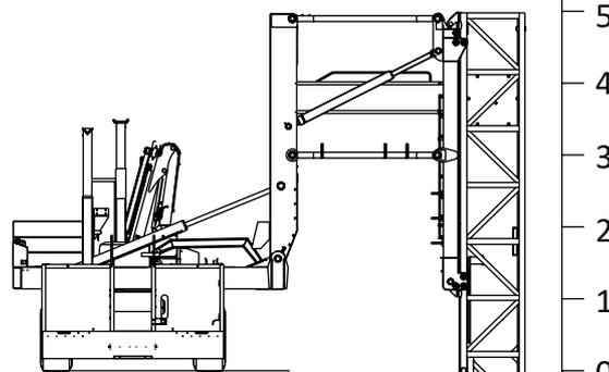
400kg au bout de la plate-forme télescopique
